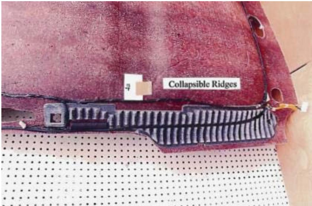
Figure 3: Collapsible Ridges<sup>9</sup>
